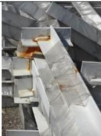
Se observa presencia de óxido en los pedestales adecuados bajo la ejecución del contrato, especialmente en las uniones de soldadura de las partes que fueron utilizadas para complementar estos elementos.
